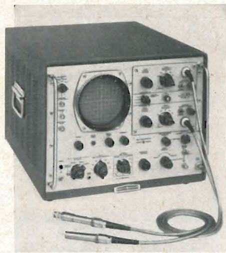
La HEWLETT-PACKARD Co., ha recentemente presentato un nuovo oscilloscopio che, basato sul principio dell'esame per campionatura, consente la visione di fenomeni impulsivi dell'ordine dei nanosecondi. Equipaggiato con l'amplificatore a doppia traccia mod. 187B, l'oscilloscopio mod. 185B presenta una banda passante tra la cc e 1000 MHz e può essere sincronizzato fino a 1000 MHz, consentendo la presentazione di segnali da 0,3 nsec a 100 \mu sec.
