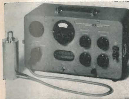
I BALLANTINE LABORATORIES, INC. annunciano l'introduzione sul mercato del nuovo voltmetro RF, mod. 393. Si tratta di uno strumento standard per laboratorio destinato alla taratura di voltmetri RF, di generatori di segnali e per misurare la risposta di frequenza di amplificatori. Lo strumento ha una portata di 1... 50 V e un campo di frequenza tra 25 Hz e 30 MHz con imprecisioni dello 0,1% fino a 10 MHz e dello 0,5% da 10 a 30 MHz. È fornito con un corredo di cinque testine. Ulteriori informazioni presso l'Agenzia Italiana della SYLVAN GINSBURY LTD., Milano.
