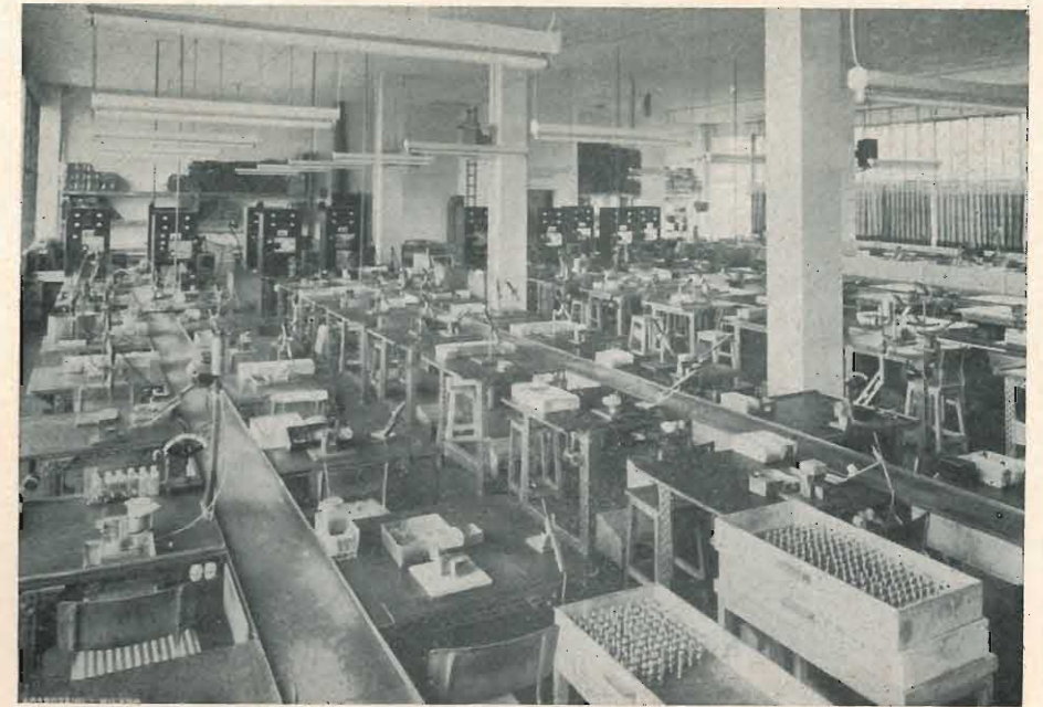
Stabilimento RICAGNI S.R.L. di Milano. Linee di montaggio dei sintonizzatori UHF.
